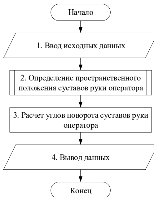
Рисунок 48 – Общий алгоритм программы модуля регистрации углов поворота руки оператора
