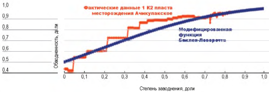
Рис. 4. Зависимость обводненности продукции от степени заводнения пласта 1 K2 верхнего мела месторождения Ачикулак. Fig. 4. The dependence of the water cut of the product on the degree of water flooding of the reservoir 1 K2 of the Upper Cretaceous of the Achikulak deposit.
