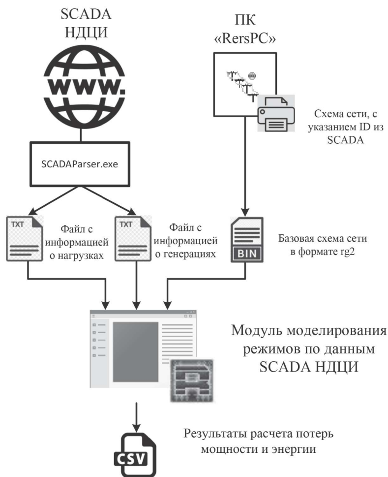
Рис. 3. Схема взаимодействия программных комплексов RersPC, RastrWin при моделировании текущих режимов по данным SCADA HDZ
