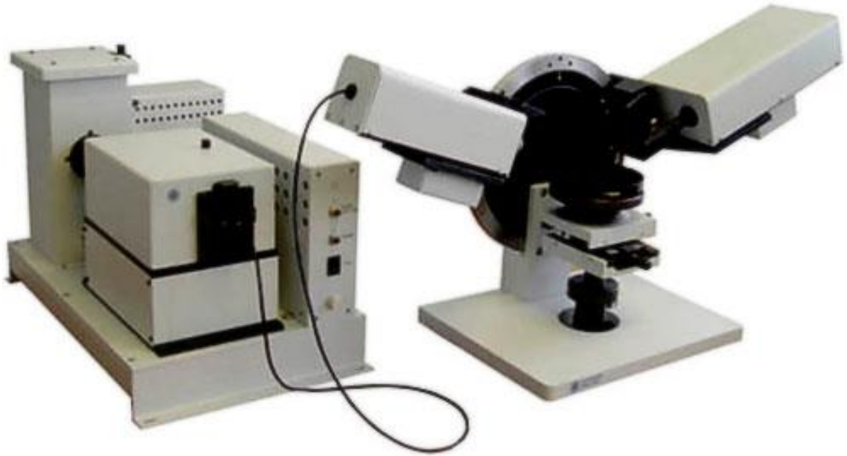
Рисунок 2.2.3 – Быстродействующий спектральный эллипсометр ЭЛЛИПС-1891
