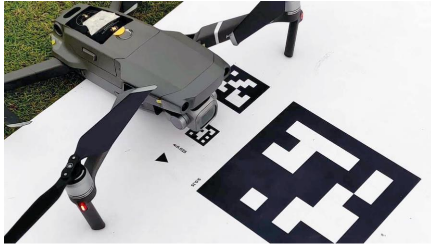
Рисунок 1.5 – Группа маркеров разного размера, нанесенных на посадочную площадку
