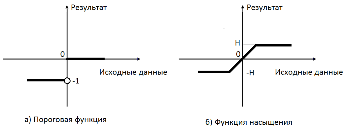
Рисунок 3.4 – вид функции активации (а) пороговая функция (б) функция насыщения
