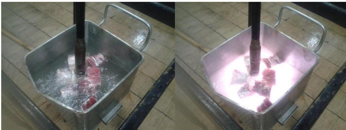
Рисунок Б1– Разрядно-импульсная обработка мясного сырья в «щадящем режиме»
