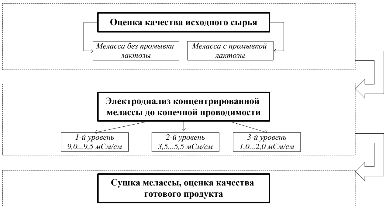
Рисунок 4.2 – Блок-схема исследований технологии получения мелассы сухой деминерализованной
