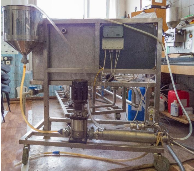
Рисунок 2.4 – Ультрафильтрационная установка для фракционирования белков
