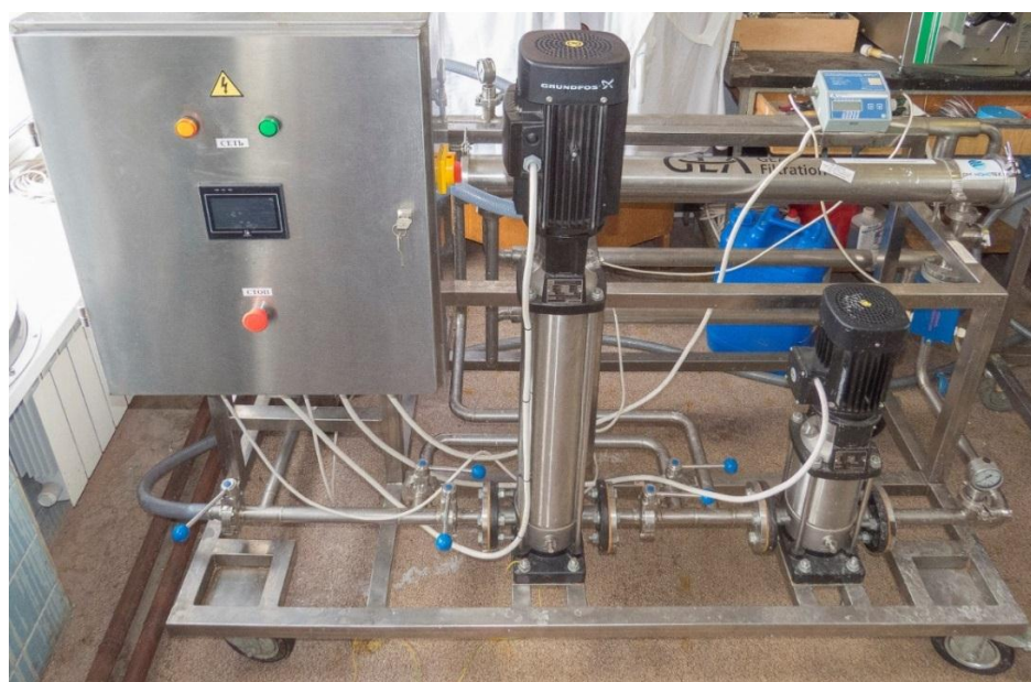
Рисунок 2.2 – Лабораторная баромембранная установка Я23-ОУН
