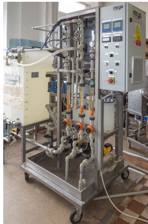
Рисунок 2.6 – Пилотная установка электродиализа
