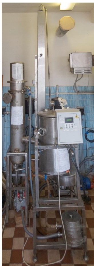
Рисунок 2.9 – Лабораторный вакуум-выпарной аппарат Я23-ОВА
