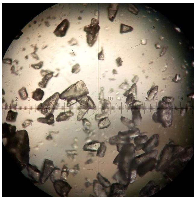
Рисунок 3.13 – Кристаллы лактозы, оптический микроскоп ( \times 100 )
