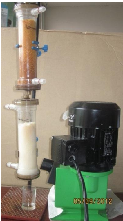
Рисунок 2.5 – Лабораторная установка ионного обмена
