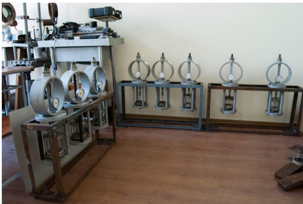
Рисунок 2.5 — Установки для испытания стандартных образцов в различных средах на одноосное нагружение
